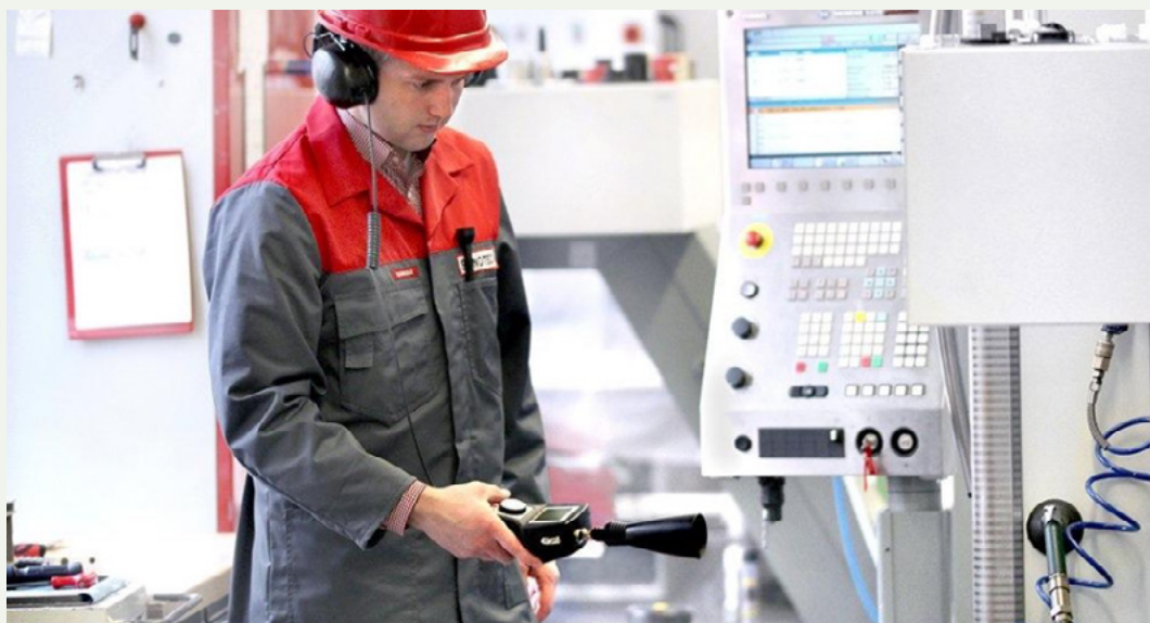
Slika 11. Detekcija gubitaka ultrazvučnim detektorom
